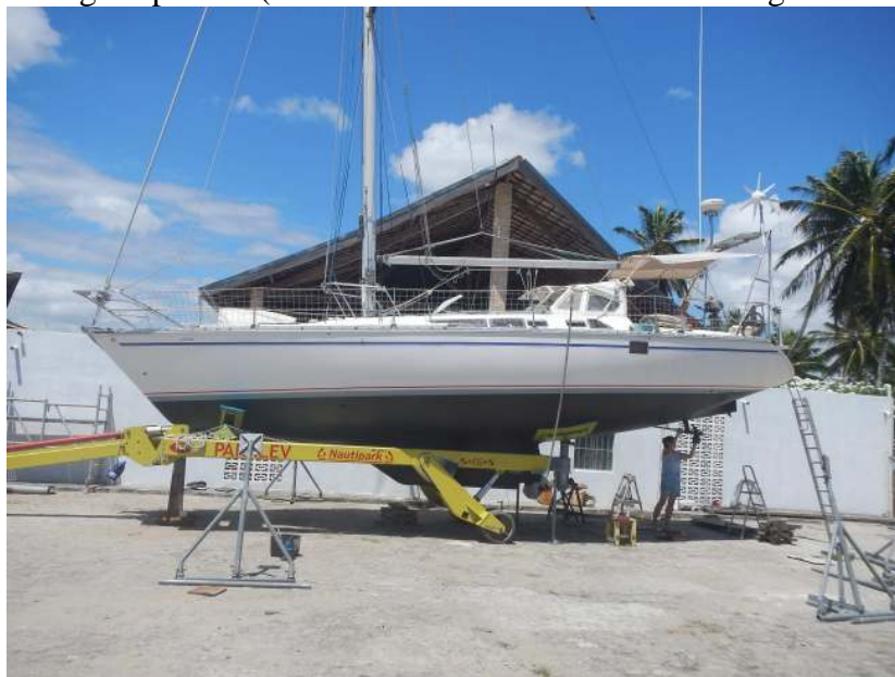
La remorque en position dépose du safran.
